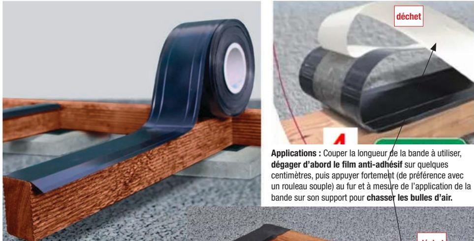
**Applications :** Couper la longueur de la bande à utiliser, dégager d'abord le film anti-adhésif sur quelques centimètres, puis appuyer fortement (de préférence avec un rouleau souple) au fur et à mesure de l'application de la bande sur son support pour **chasser les bulles d'air**.
